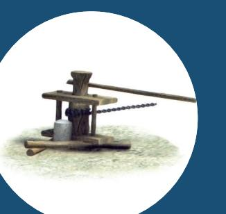
**El Borriquillo:** Es un torno que se ajusta a los hitos de amarre para dejarlo fijo y así poder hacer fuerza con él, tirando de la palanquilla. La cadena se enrosca al torno por un lado, y por el otro se ata al palo de gobierno. De esta forma, haciendo palanca, se puede mover todo el peso de la caperuza.
